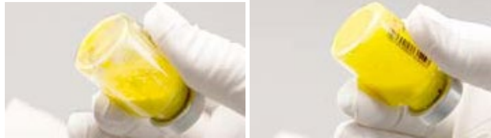
Abbildung B: Kontrollieren auf nicht suspendiertes Pulver und wiederholtes Aufklopfen wenn erforderlich.
