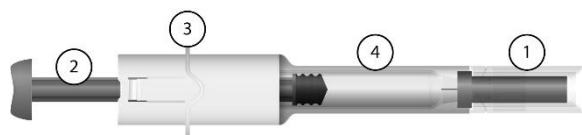
Figur 1. Injektionssprøjte med automatisk beskyttelsessystem af nålen
